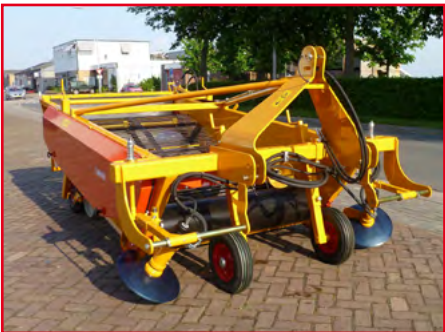
2x Angetrieben Scheibe in kombination mit Engere Maschine
