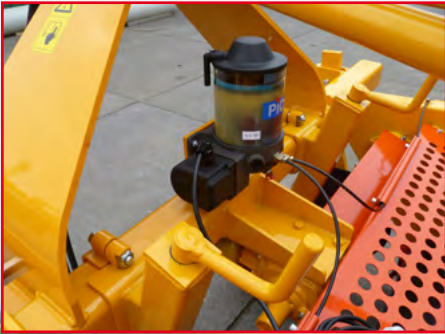
Automatisches Schmiersystem für Lager Rodewelle
