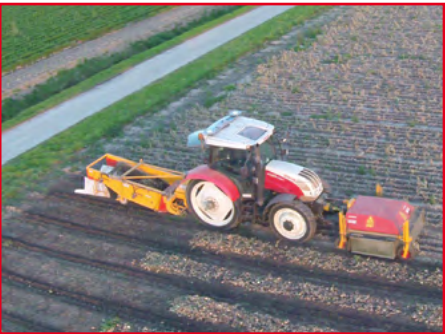
2e Siebkette hydr. angetrieben mit Elektrischen Drehstopp
