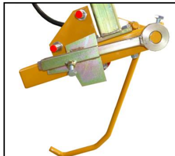
Placement du bras de réaction avec la plaque par rapport aux capteurs.
